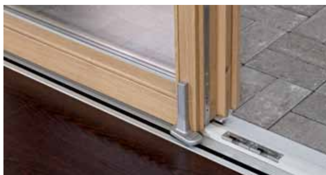
Kerekesszékes vagy mozgásában korlátozott személy által használható, akadálymentes küszöb, melyen nincsenek a padló síkjából kiemelkedő (pl. a szárny padlóhoz rögzítését szolgáló) tokalkatrészek
