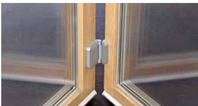
Állítható magasságú harmonika pánt, kívülről azonban rejtett csavarozás a magasabb szintű betörésvédelem érdekében
